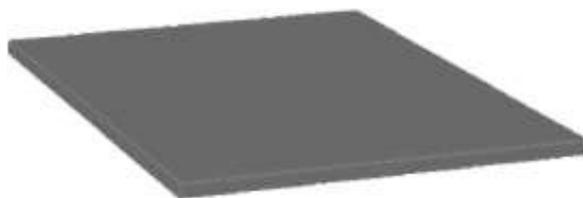
Dosky z pórovitej gumovej zmesi, ktoré sa vyznačujú veľmi nízkou tvrdosťou. Použitá zmes je SBR - Styren Butadien kaučuk. Mikroporézne dosky sú najčastejšie používané pre výrobu konštrukčných prvkov k vymedzovaniu vôle, pre výrobu mäkkých tesnení, k dotesňovaniu prírub, ako tlmíč vibrácií a hluku v strojárstve a vzduchotechnike atď.
