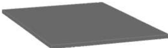
Polychloroprenový kaučuk (**Neoprén**) sa používa tam, kde sú požiadavky na odolnosť proti poveternosti, ozónu a ohni (samozhášavý) a na dobrú adhéziu. Dobre odoláva rozpúšťadlám a stredne olejom.
