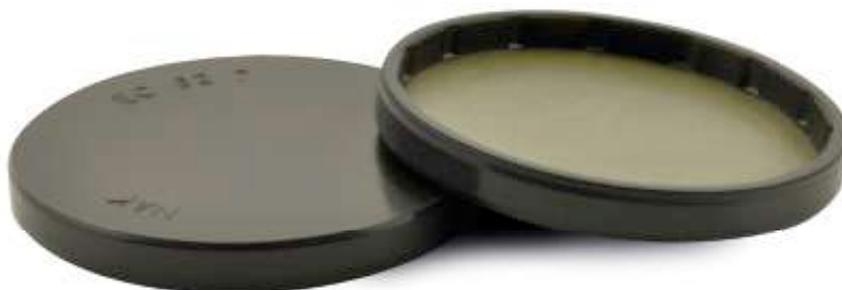
**Tesniace veká VER01** slúžia k bezpečnému tesneniu montážnych a iných otvorov, napríklad v prevodovkách. Je ich možné použiť ako kryty ložísk. Tesniace veká majú hladký vonkajší gumový plášť, ktorý zaisťuje dobrú statickú tesnosť. Sú vhodné pre delené zástavbové priestory a pre tesnenie nízko viskózných kvapalných alebo plynných médií.
